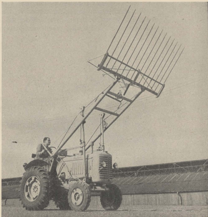
Elévateur porté pour fourrage - RENAULT-FAUCHEUX Hauteur de levage : 3 m. Capacité de chargement : 8 à 10 t. à l'heure
