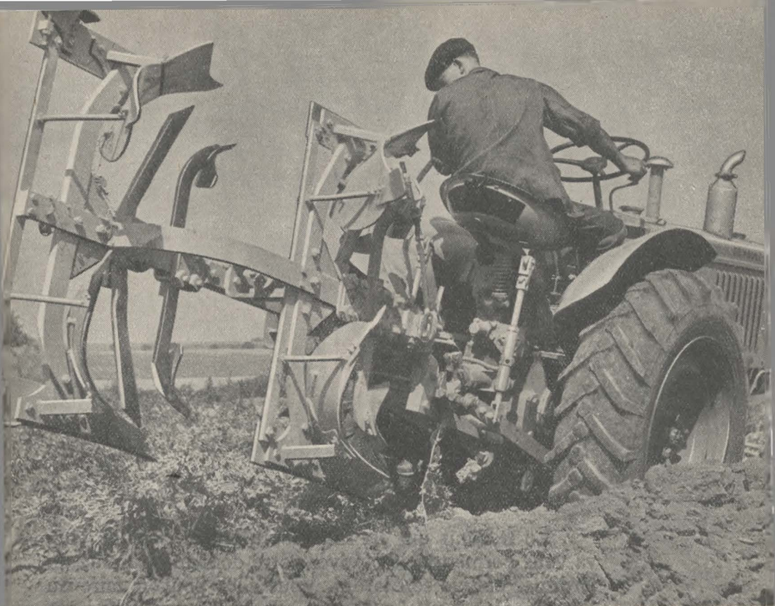
Charrue Portée RENAULT- PONTCHAL bisoc-reversible 12 pouces.
