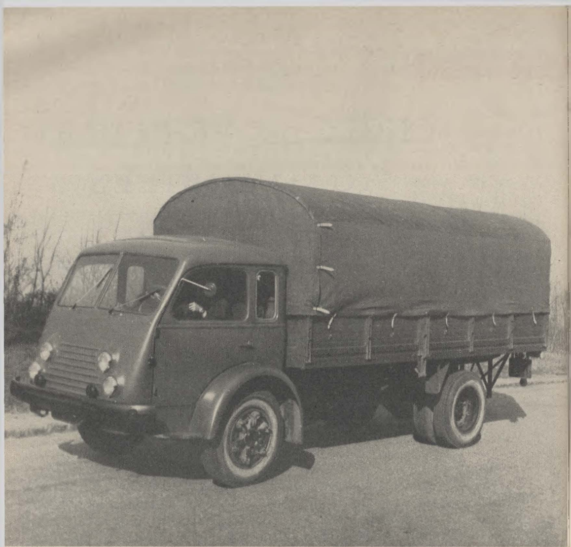
Camion RENAULT 7 tonnes de charge utile - Moteur à plat.
